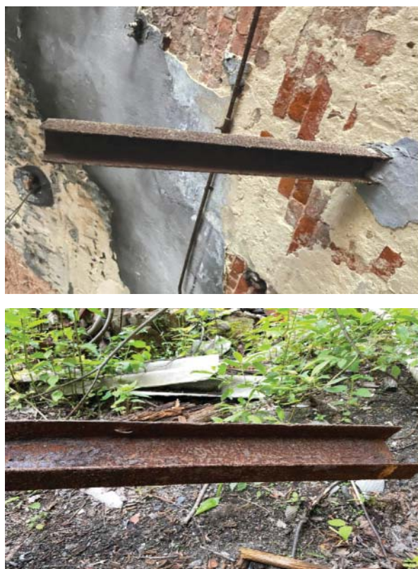
Рис. 1. Внешний вид исследуемого образца стальной конструкции (швеллер) из здания текстильного комбината имени III Интернационала
