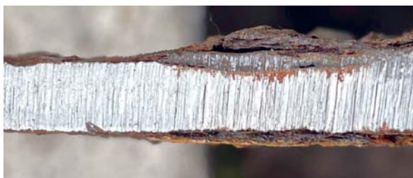
Рис. 5. Внешний вид участка со следами значительной коррозии стального образца (срок эксплуатации с 1936 г.) — место отбора образца Ш-4
