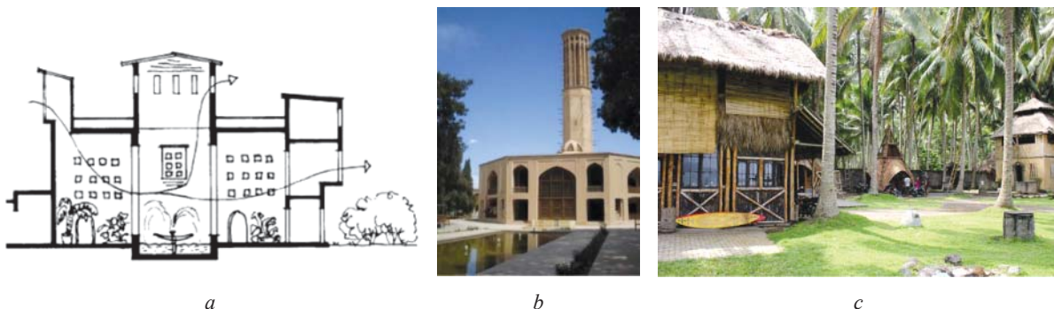
Рис. 1. Применение испарительного охлаждения в Персии (a, b) и в Индии (c)
