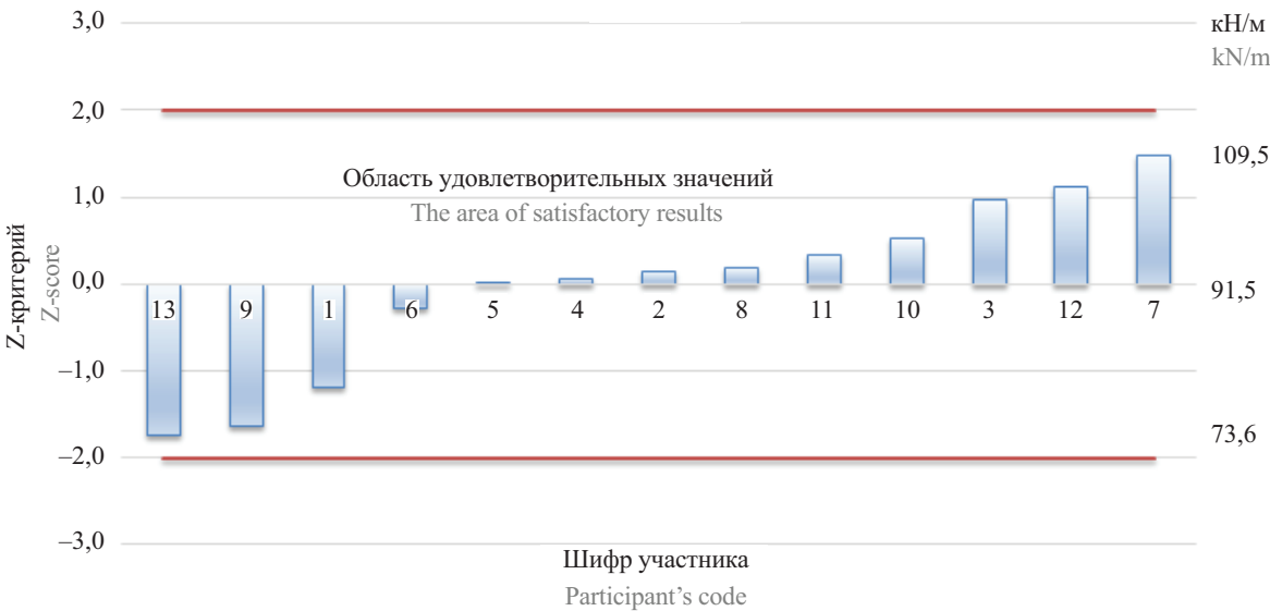
Рис. 1. График Z-критерия для прочности при растяжении в продольном направлении T_{\text{н}} геосинтетического материала. Образец № 1
