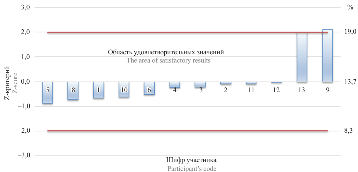
Рис. 3. График Z-критерия для относительного удлинения геосинтетического материала при максимальной нагрузке в продольном направлении. Образец № 1
