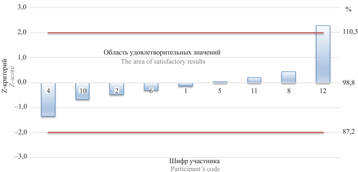
Рис. 5. График Z-критерия для показателя морозостойкости геосинтетического материала (30 циклов) в продольном направлении. Образец № 1
