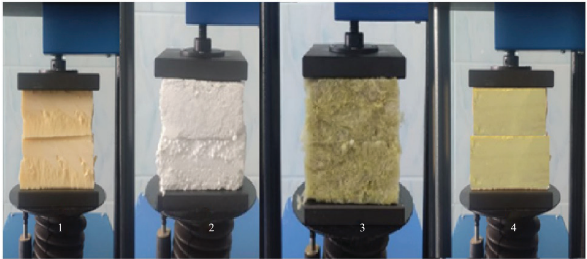
Рис. 2. Опытные образцы теплоизоляционных материалов: 1 — пенополистирол; 2 — пенопласт; 3 — минеральная вата; 4 — пенополиуретан
