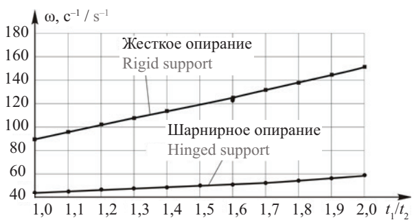
Рис. 3. Изменение частот собственных колебаний в зависимости от соотношения толщины пластины t_1 на опоре к толщине t_2 в центре
