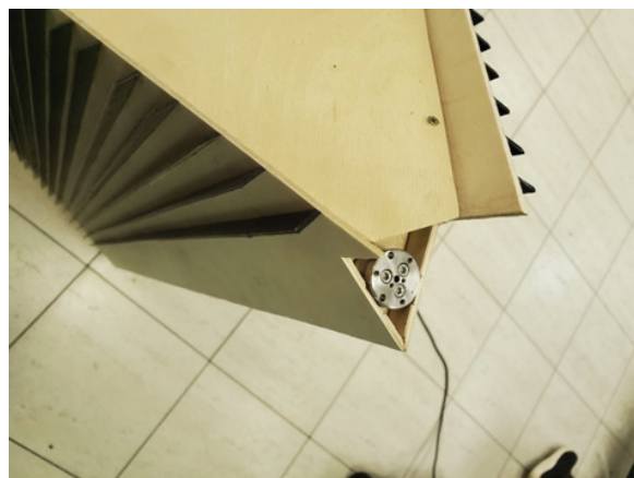
Рис. 11. Узел крепления шестикомпонентного силомоментного датчика
