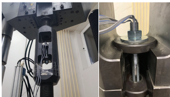
Рис. 5. Испытание шпильки с прорезями
