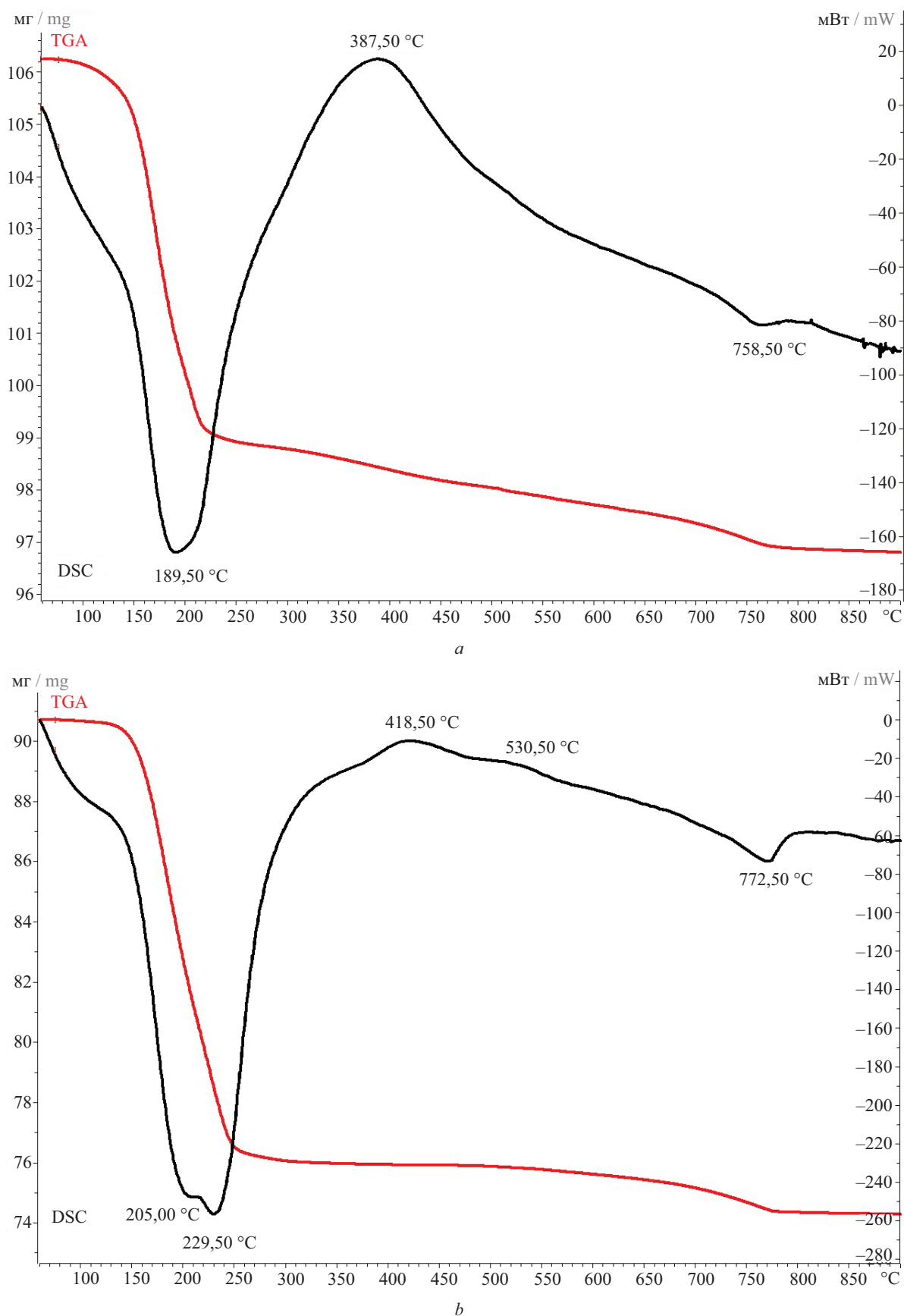
Рис. 3. Дифференциально-термический и термогравиметрический анализ ангидритового вяжущего с использованием в качестве активатора твердения ЦЕМ I (а) и сульфата железа (б) в количестве 3 % от массы вяжущего
