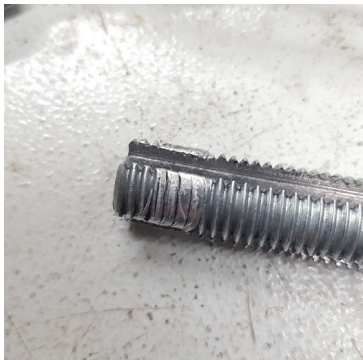
Рис. 10. Шпилька после испытания и разрушения гайки
