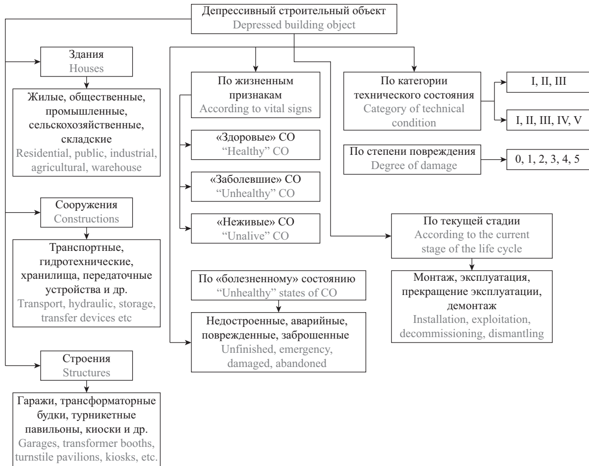
Рис. 2. Классификация ДСО с точки зрения визуального дешифрирования
