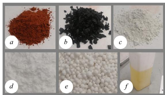
**Рис. 1.** Используемые материалы: *a* — тонкодисперсная кирпичная крошка; *b* — отходы сшитого полиэтилена; *c* — портландцемент белый ПЦБ 1-500-Д0; *d* — белая сажа БС-120; *e* — хлорид кальция технический; *f* — пластификатор П-17
