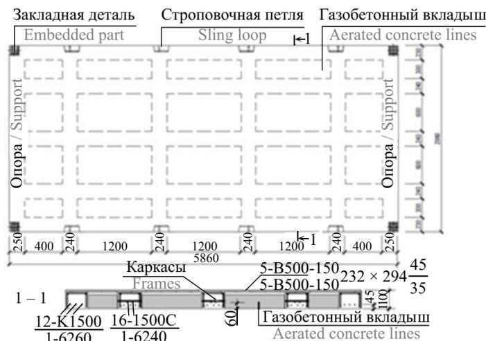
Рис. 1. Общий вид и схема армирования сборной предварительно напряженной железобетонной ребристой плиты перекрытия
