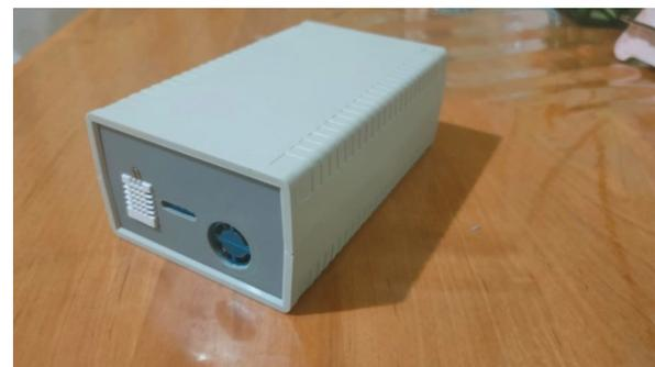
Рис. 3. Измеритель концентрации мелкодисперсных аэрозолей (ПИКМА)
