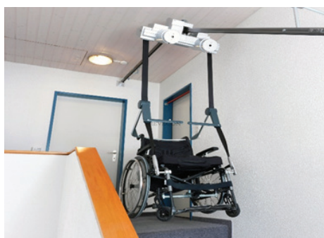
Рис. 7. Подвесное подъемное устройство Fig. 7. A ceiling lift
