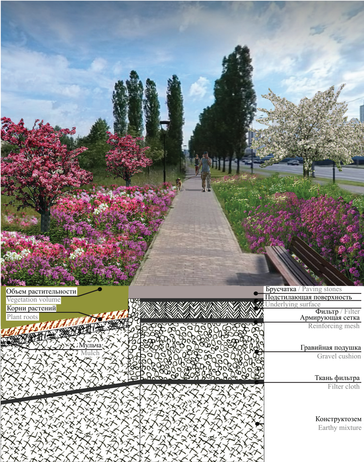
Рис. 5. Перспективный вид инженерно-технического дизайна на территории исследования (рисунок авторов) Fig. 5. A prospective view of engineering and technical design in the research area (authors' scheme)
