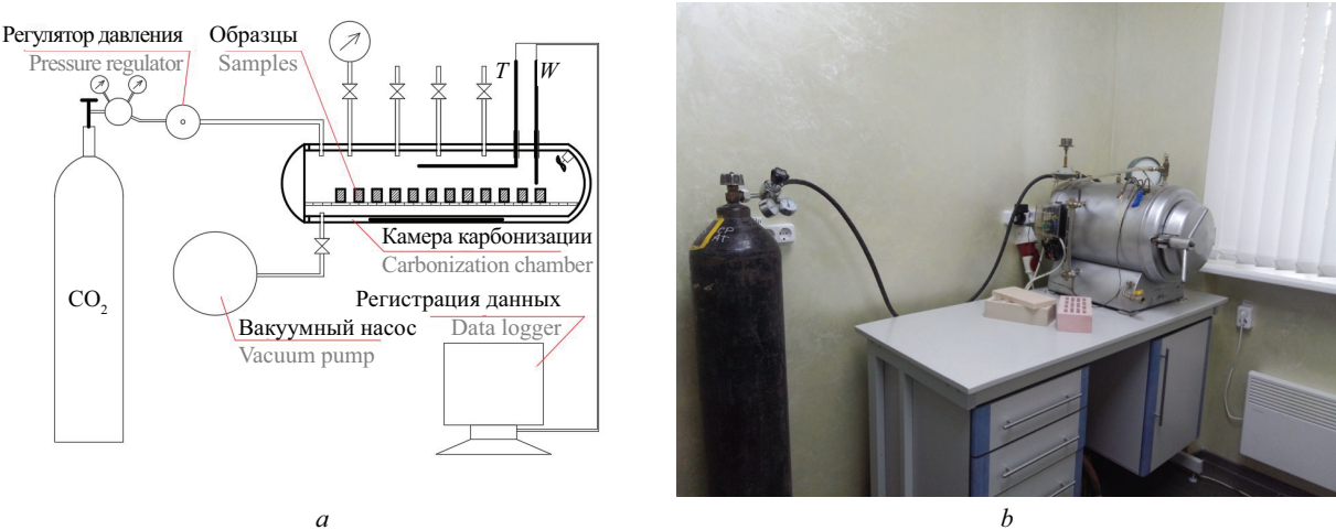
Рис. 4. Схема (а) и общий вид (б) камеры принудительной карбонизации Fig. 4. Scheme (a) and general view (b) of the forced carbonization chamber
