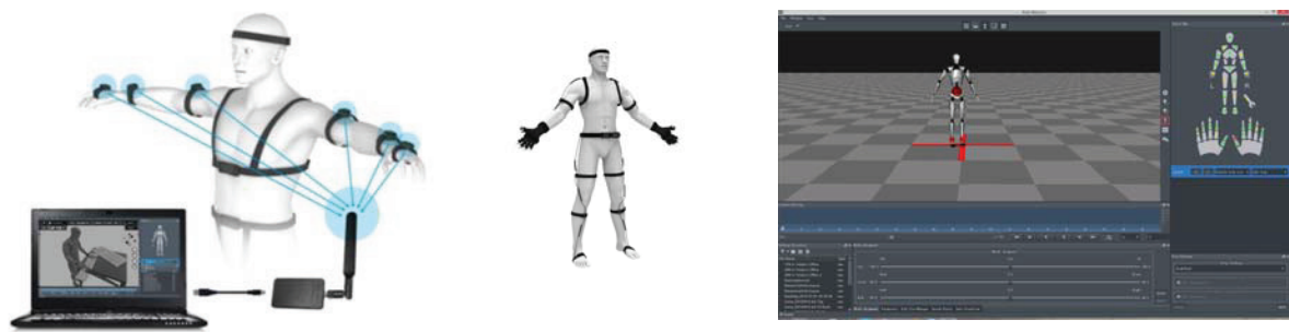
Рис. 2. Схема размещения датчиков и пример работы системы Perception Neuron 8,9 Fig. 2. The layout of the sensors and an example of the Perception Neuron system 8,9
