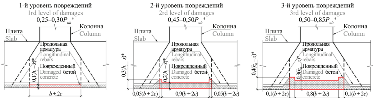
Рис. 8. Моделирование локальных повреждений, вызванных продавливанием
