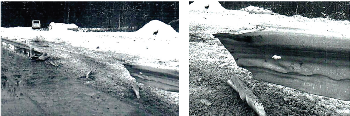
Рис. 2. Разрыв балки БДО при проведении полномасштабных натурных испытаний Fig. 2. Rupture of guardrail barrier beam during full-scale crash test
