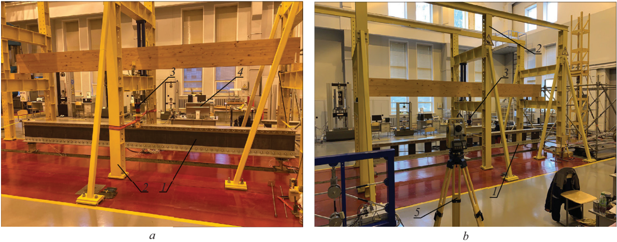
Рис. 3. Испытательный стенд и экспериментальные образцы из ПСП: a — со сплошной стенкой; b — с перфорированной стенкой: 1 — экспериментальный образец, 2 — испытательный стенд, 3 — гидравлический домкрат, 4 — тензостанция, 5 — тахеометр
