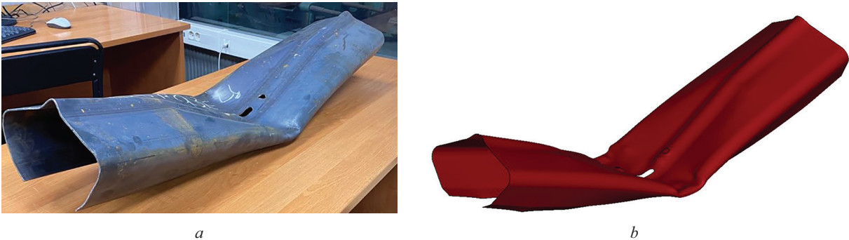
Рис. 23. Балка после стендовых испытаний: a — натурных; b — виртуальных Fig. 23. Beam after bench tests: a — full-scale; b — virtual
