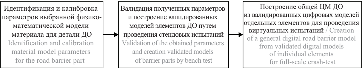
Рис. 4. Типовая схема построения валидированных цифровых моделей дорожных ограждений
