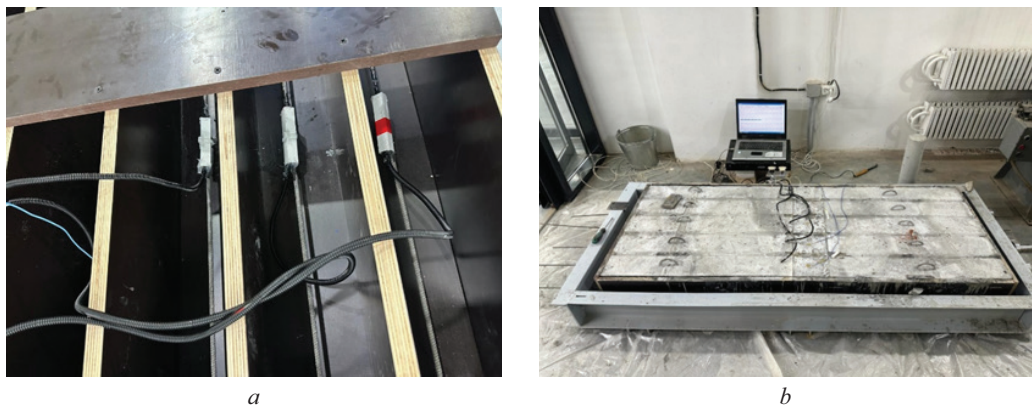
Рис. 7. Тензодатчики на стержнях в защитной оболочке ( a ); фиксация напряжений в арматуре во время набора прочности бетона ( b )
