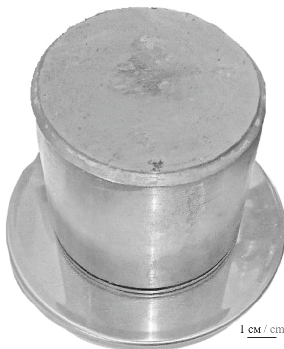
Рис. 3. Испытуемый образец доломитовой муки в режущем кольце
