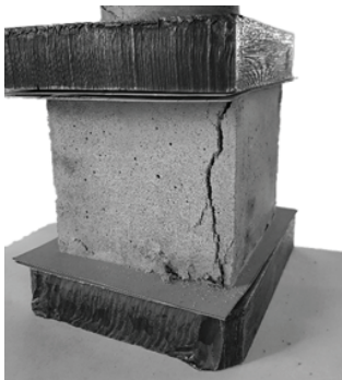
Рис. 4. Кубик из мелкозернистого бетона после испытания на сжатие
