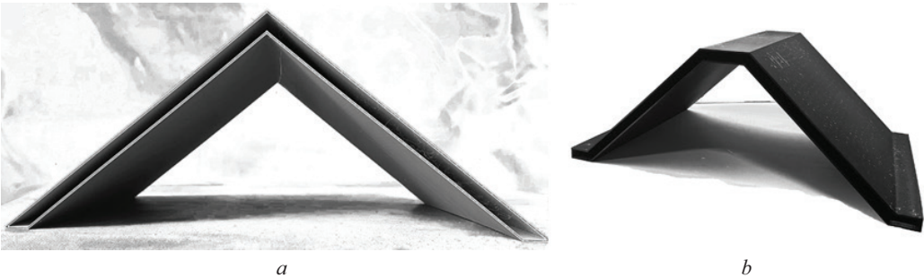
Рис. 2. Опалубочные формы: a — треугольная складка; b — трапецидальная складка Fig. 2. Molds: a — triangular fold; b — trapezoidal fold
