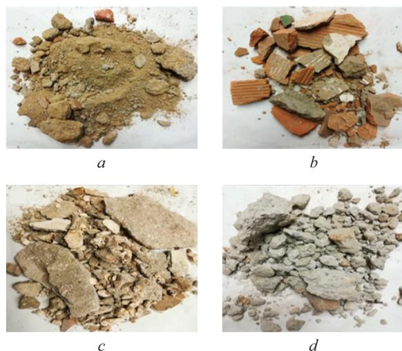
Рис. 4. Некоторые образцы отходов строительства и сноса зданий [17]
