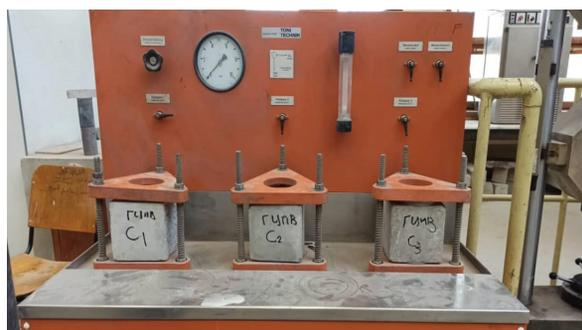
Рис. 1. Установка для испытания образцов бетона по глубине проникновения воды под давлением
