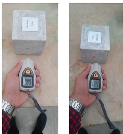
Рис. 9. Измерение разности температур для первой группы смесей (GCP 50 %)
