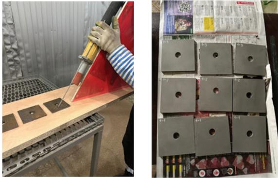
Рис. 2. Шаблон для обеспечения угла распыления и расстояния до поверхности элемента
