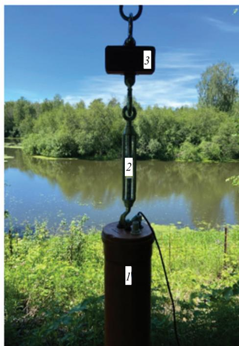
Рис. 4. Общий вид установки по определению коэффициента трения вакуумного анкера о донный грунт: 1 — пластиковый трубный вакуумный анкер с погружным электронасосом внутри; 2 — талреп; 3 — крановые весы
