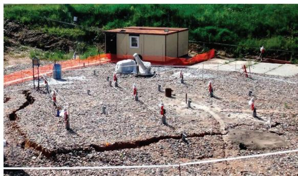
**Рис. 1.** Проведение работ по подъему массива грунта над моделью фундаментной плиты на площадке опытного участка Загорской ГАЭС-2
