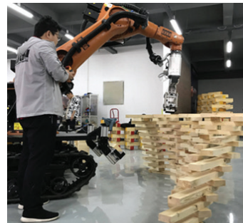
Рис. 2. Робот строит арку [8]
