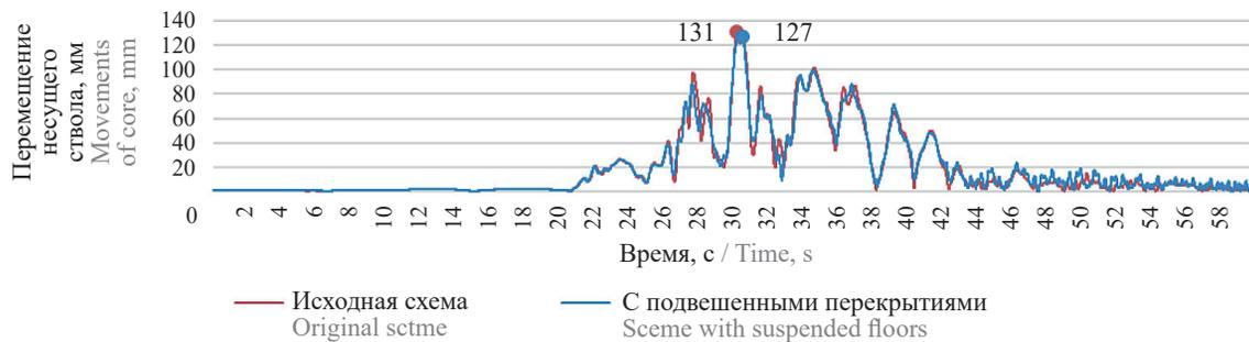
Рис. 12. Перемещения стволос расчетных моделей при  $M = 12,8\%$  с жесткими связями и при  $M = 19,6\%$  с упругими связями  $R = 25$  тс/м
