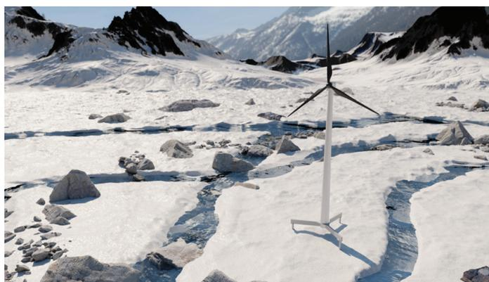
Рис. 17. Визуализация арктической ВЭУ с предложенным вариантом опорных конструкций
