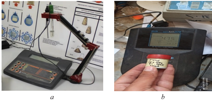
Рис. 3. Оборудование для измерения ГЦПВ суспензий: a — на рН-показатель; b — на электропроводимость Fig. 3. Equipment for measuring the GCPB of suspensions: a — for the pH indicator; b — for electrical conductivity
