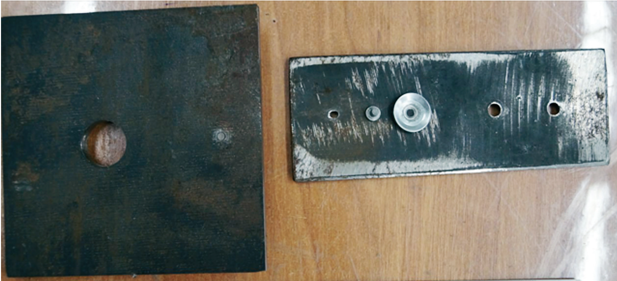
Рис. 14. Вид стальных пластин и дюбеля после разрушения однодюбельного соединения Fig. 14. View of the steel plates and dowels after the destruction of the single-tube connection
