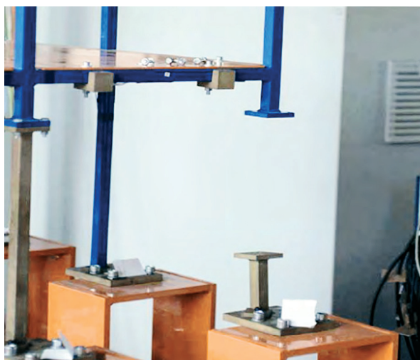
Рис. 2. Опираание конструкции на балочную систему
