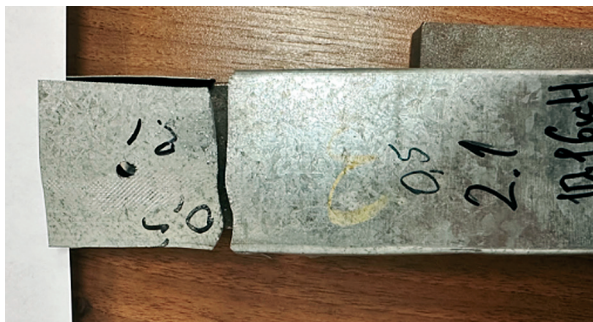
Рис. 7. Характерные повреждения оцинкованного листа в образцах 2-го типа
