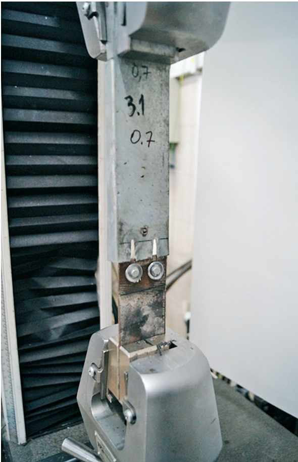
Рис. 9. Характерные повреждения оцинкованного листа в образцах 3-го типа Fig. 9. Characteristic damages of galvanized sheet in specimens of type 3
