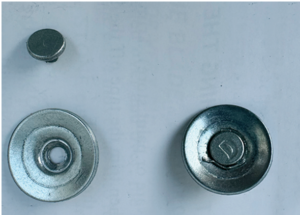
Рис. 12. Оторванные головки дюбелей после их установки в отверстия диаметром 3 мм Fig. 12. Detached dowel heads after their installation in holes with a diameter of 3 mm
