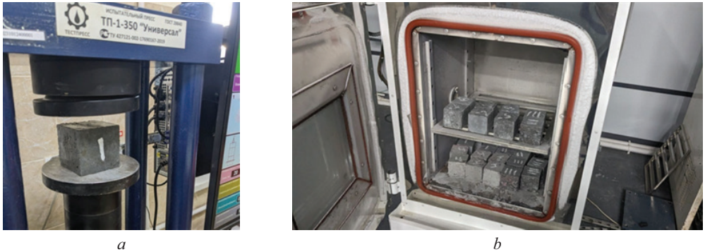
Рис. 2. Определение прочности (а); морозостойкости (b) Fig. 2. Determination of strength (a); frost resistance (b)
