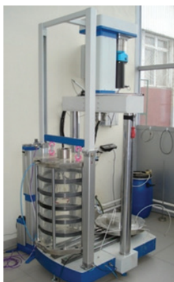
Рис. 1. Общий вид установки для проведения испытаний на трехосное сжатие
