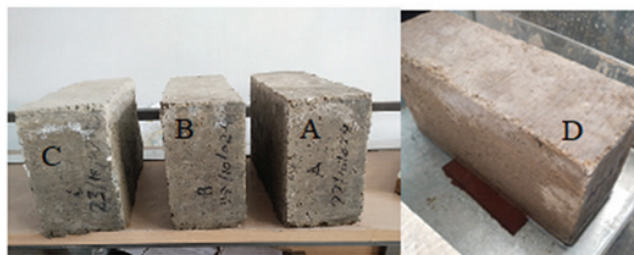
Рис. 8. Влажное состояние кирпича после капиллярного водопоглощения
