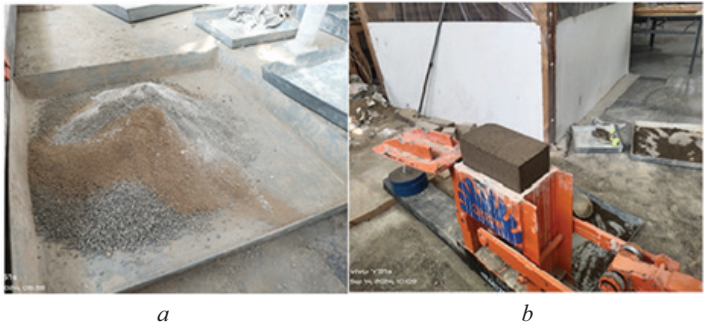
Рис. 1. Исходные материалы для ССГК (а); формовочная машина для производства ССГК (b) Fig. 1. Show compressed stabilized earth bricks (CSEB) raw materials (a); molding machine CSEB production (b)
