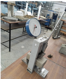
Рис. 3. Испытание ССГК на прочность при изгибе Fig. 3. Illustrates the flexural strength test on compressed stabilized earth brick
