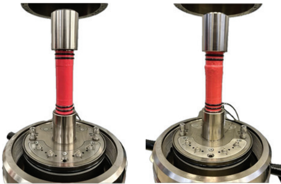
Рис. 10. Образец в приборе трехосного сжатия до и после испытания
