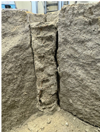
Рис. 12. Фрагмент образца после испытания. Разрушение области контакта «свая – массив»
