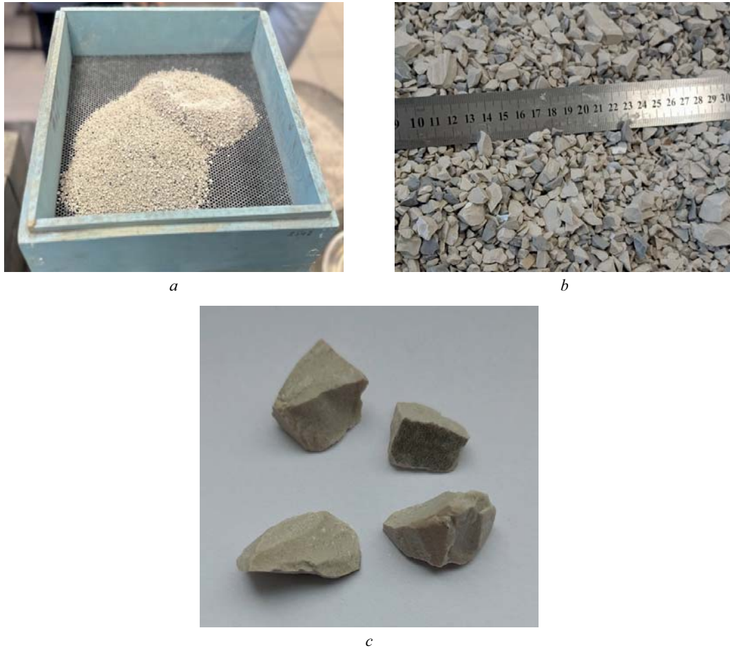
Рис. 1. Общий вид: a — мелкого заполнителя из боя КГП; b — крупного заполнителя из боя КГП; c — отдельных зерен боя КГП, используемого в качестве крупного заполнителя
