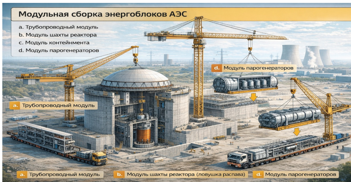
Рис. 1. Принципиальная схема модульной сборки энергоблока АЭС
